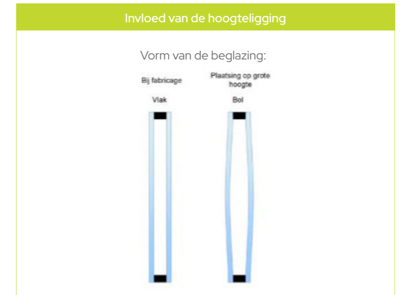
Figuur 21: Vervormingen van een isolerende beglazing te wijten aan hoogteschommelingen
