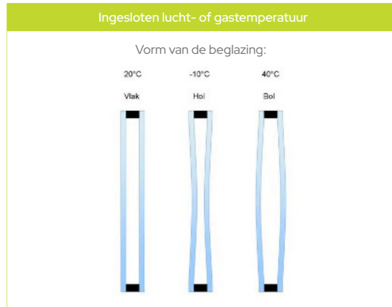
Figuur 19: Vervormingen van een isolerende beglazing te wijten aan temperatuurschommelingen.
